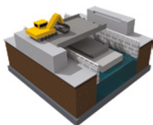
Le pont actuel sera découpé longitudinalement en 8 « colis », qui seront évacués par barge sur l'Escaut
