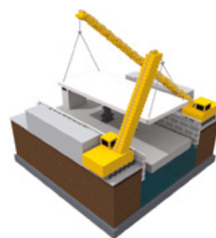
Deux grues de 650 tonnes chacune vont soulever l'imposante structure métallique
